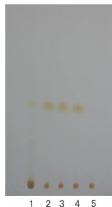
图6 郁金薄层色谱图(日光)
